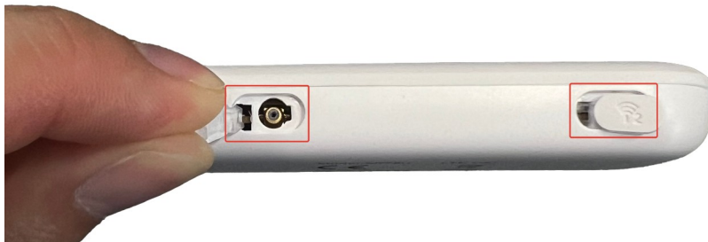
Рисунок 12 – Разъемы для подключения внешних антенн
